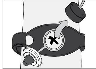
2. Nehmen Sie die Sonde vorsichtig aus der Aufnahme heraus. Nicht am Kabel ziehen! Durch kräftiges Ziehen am Kabel beim Herausnehmen kann sich die Verbindung zur Sonde lösen. In diesem Fall muss das EXOGEN-Gerät zur Reparatur eingeschickt werden.
