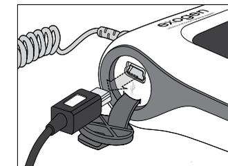
6. Entfernen Sie den USB-Stecker nach Beenden des Ladevorgangs aus dem EXOGEN-Gerät und das andere Ende des Kabels aus der Wandsteckdose, und schließen Sie die Abdeckung für den USB-Anschluss.
