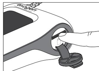
4. Drücken Sie auf die Therapie-Karte, bis ein Klicken zu hören ist, und lassen Sie sie anschließend los. Die Karte sollte nun weit genug aus dem Gerät herausragen, sodass Sie sie greifen können.
