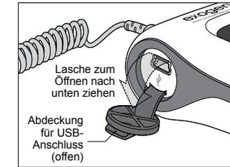
2. Ziehen Sie die Lasche nach unten, um die Abdeckung für den USB-Anschluss zu öffnen.
