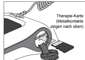
3. Setzen Sie die Karte mit den Metallkontakten (nach oben gerichtet) voran in den Kartensteckplatz ein. Drücken Sie die Karte in das EXOGEN-Gerät, bis sie mit einem Klicken einrastet.
