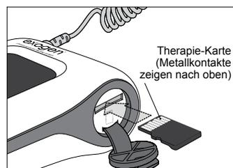
5. Entnehmen Sie die Therapie-Karte aus dem EXOGEN-Gerät, und entsorgen Sie sie.
