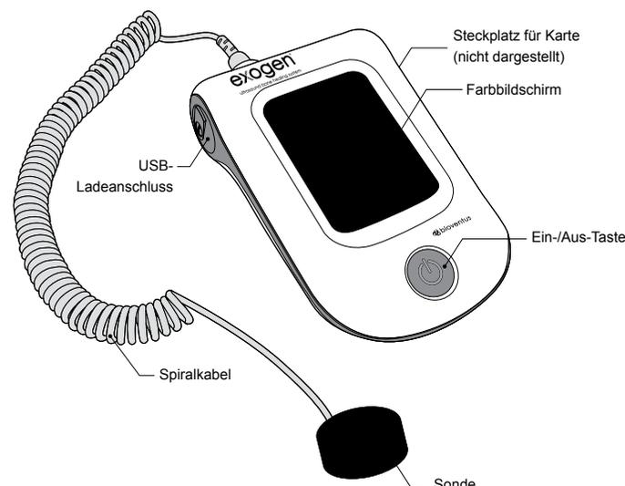
Abbildung 2 – EXOGEN-Gerät (Teilnr. 71034451)
