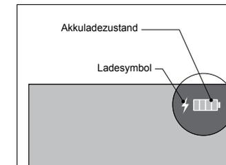
5. In der Ecke des Bildschirms blinken das Ladesymbol (weißer Blitz) und das Akkuladezustandssymbol auf. Das Ladesymbol mit dem Blitz weist darauf hin, dass das EXOGEN-Gerät aufgeladen wird. Laden Sie das EXOGEN-Gerät so lange auf, bis eine vollständig geladene Batterie im Akkuladezustand angezeigt wird.
