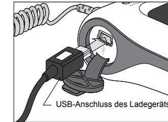
3. Schließen Sie das eine Ende des Ladegeräts an eine Steckdose an. Schließen Sie das Ende des Ladegeräts mit dem USB-Stecker an den USB-Anschluss an.
