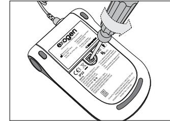
3. Entfernen Sie die Schraube für die Abdeckung des Akkufachs mithilfe eines Schraubendrehers.
