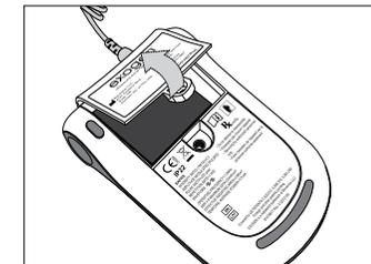
4. Nehmen Sie die Abdeckung des Akkufachs ab, indem Sie sie an der Lasche nach oben ziehen.
